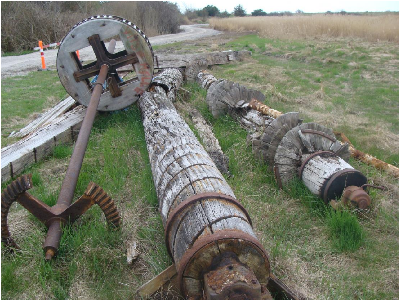
Resterne af archimedessneglen og andet udstyr fra den hollandske mølle i Vitsø Nor. Bemærk, at bortset fra jernbåndene, er archimedesskruen helt af træ. Et imponerende tømrerarbejde. Foto: Kurt Due Johansen,
