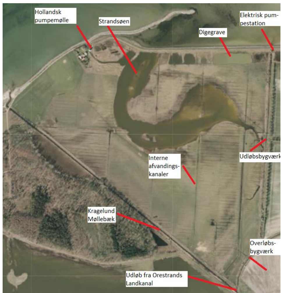
Afvandingstekniske elementer på Reservatet.
